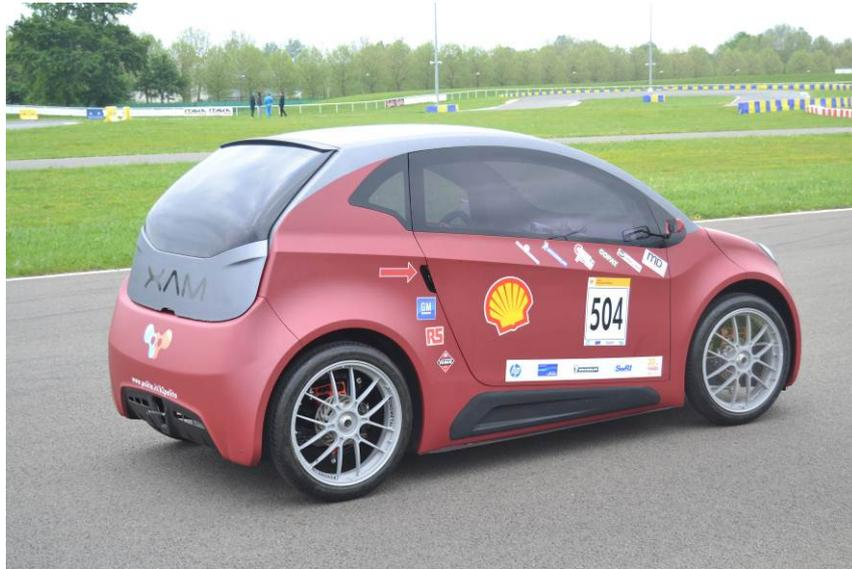
**IDRAkronos:** monoscocca in fibra di carbonio, massa di 39 kg, motore elettrico da 200 W e fuel cell a idrogeno da 500 W, aerodinamica efficiente e  $C_x=0,09$ .
